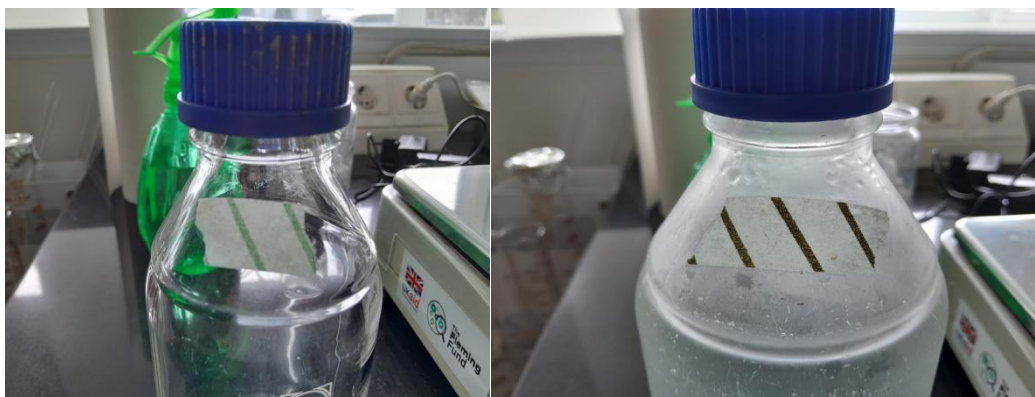
Gambar 3. Indikator tape yang belum disteril (kiri) dan indikator tape yang sudah disteril (kanan)
