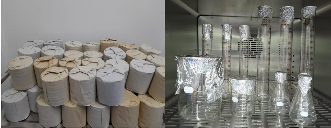
Gambar 1. Contoh sterilisasi kering pada cawan petri (kiri) dan sterilisasi glassware (kanan)
